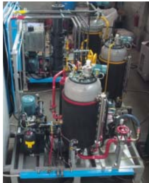
Una dosatrice a pistoni è in grado di alimentare un sistema di spruzzo SoliSpray.
