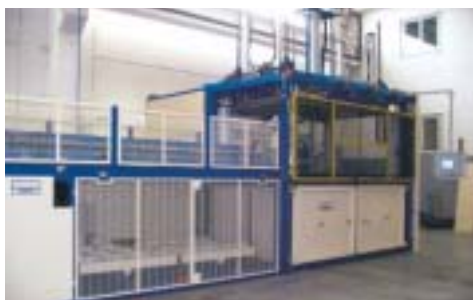
Termoformatrice Powerform con stazione di carico lastra e scarico del pezzo finito.
