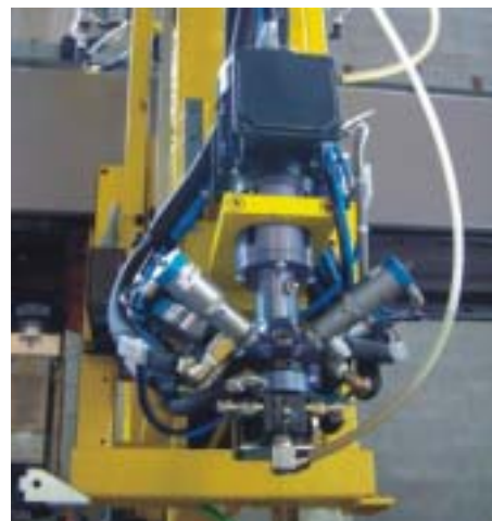
La nuova testa di miscelazione Cannon B1-Multi ha 6 iniettori: 4 per i componenti e 2 per la pulizia.
